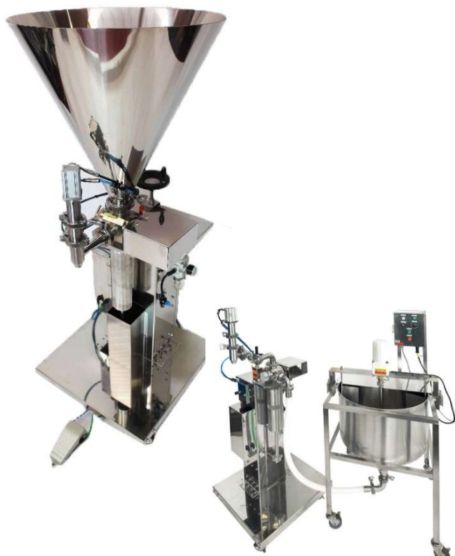
別置きタンクからの底抜き設定例
